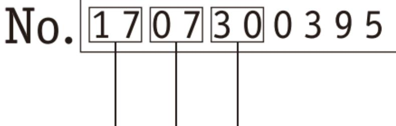
Дата изготовления изделия зашифрована в серийном номере, напечатанном на корпусе инструмента. Первые 2 цифры обозначают год выпуска, следующие 2 цифры – месяц и следующие 2 цифры - день.
